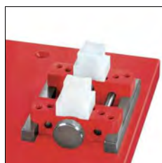
Possibilité d'utiliser des tasseaux entre-cornes. (voir page 07-28)
