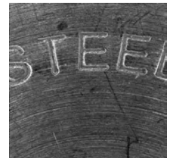
BF + DF Éclairage épiscopique et rasant
