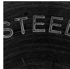
DF Éclairage rasant
