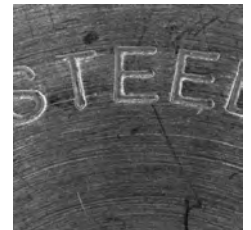
BF + DF Éclairage épiscopique et rasant
