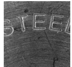
BF + DF Éclairage épiscopique et rasant
