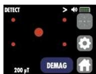
Sensores de detección : hay 5 sensores y uno de ellos está situado en el centro de la superficie de detección.
