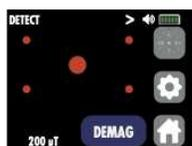
Sensori di rilevazione : ci sono 5 sensori e uno di loro è situato nel centro della superficie di rilevazione. Gli altri si trovano negli angoli di un quadrato di 1.5 cm. I sensori possono misurare la forza del magnetismo e la sua posizione. Un punto sullo schermo LCD indica un sensore con la sua posizione e la dimensione del punto è proporzionale alla forza magnetica.
