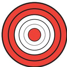
Per verificare il grado di magnetismo delle piccole forniture (per esempio viti), si raccomanda di piazzare nelle aree bianche dell'esempio qui riportato. Il sensore posto al centro e le due zone tra i 3 cerchi esterni (in rosso) non rilevano il grado di magnetismo delle piccole forniture.
