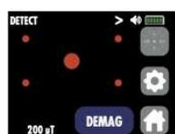
Capteurs de détection : il y a 5 capteurs et l'un d'eux est situé dans le centre de la surface de détection. Les autres se trouvent dans les angles d'un carré de 1.5 cm. Ils peuvent mesurer la force du magnétisme ainsi que sa position. Un point sur l'écran LCD montre un capteur avec sa position et la taille du point est proportionnelle à la force magnétique.
