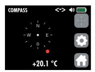
Affichage du sous-menu **COMPASS** (le point rouge indique le nord magnétique réel. On peut également contrôler la justesse des montres équipées d'une boussole par rapport au point rouge).
