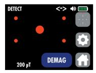
Affichage du sous-menu DETECT avec un objet magnétisé posé sur la surface DETECT ZONE
