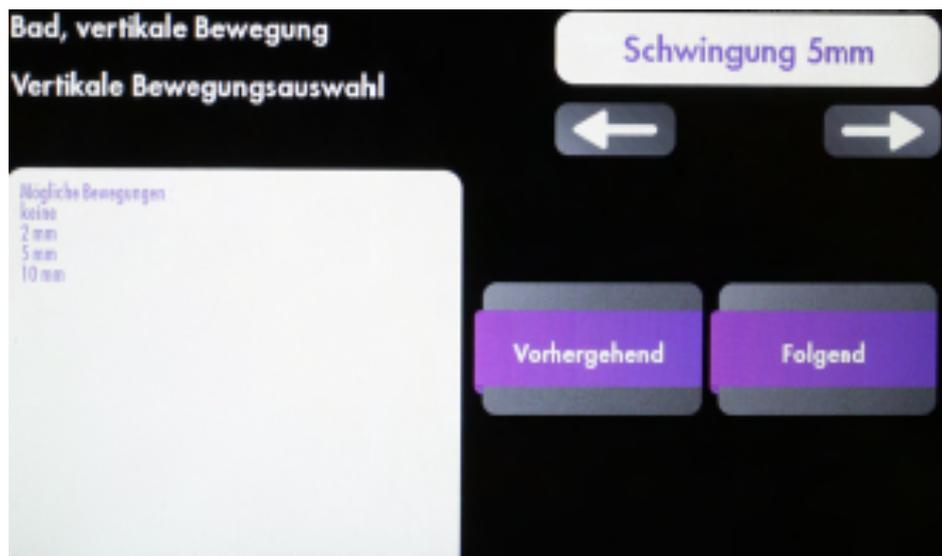
Die vertikale Bewegung kann null sein (Stopp) oder auf 2, 5 oder 10 mm Breite eingestellt werden. Die Taktfrequenz dieser Bewegung kann ebenfalls von 1 bis 100 Zyklen pro Minute eingestellt werden. Die vertikale Bewegung sorgt dafür, dass die Teile in der Reinigungsflüssigkeit gut durchmischt werden.
