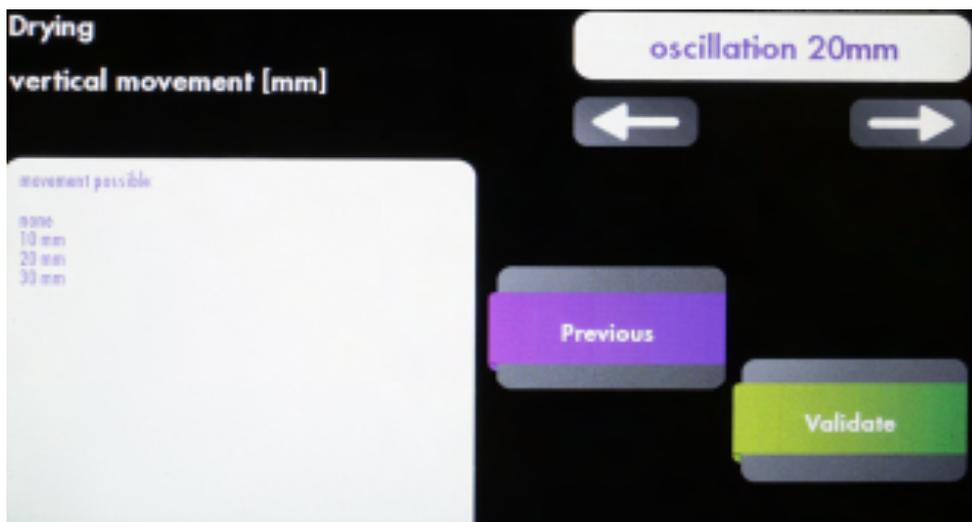
Die vertikale Bewegung kann null sein (Stopp) oder auf 10, 20 oder 30 mm Amplitude parametrierbar sein. Diese Bewegung ermöglicht eine gleichmäßige Trocknung über die gesamte Höhe des Korbbalters.
