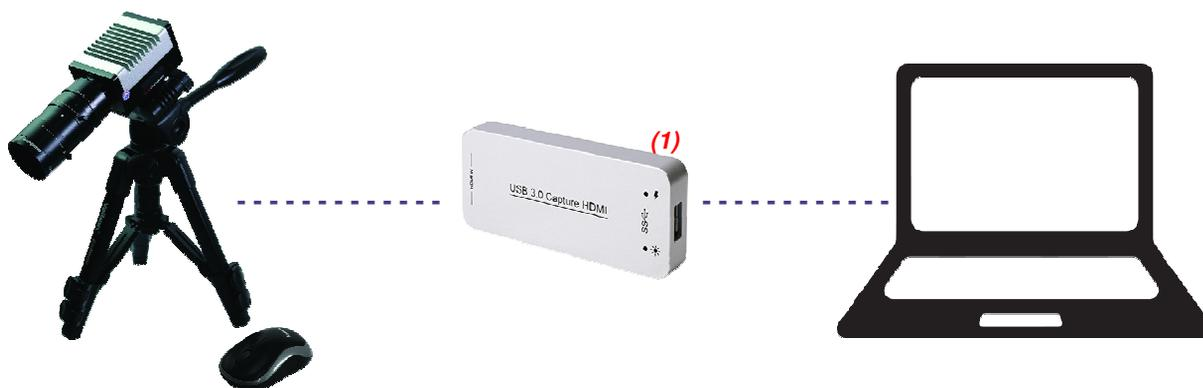
Connectez votre système d'inspection HOROTEC (SMV-B / SMV-2 / SMV-3) avec le convertisseur de signal HDMI/USB 3.0 (MSA14.151-U) et partagez en "Live" votre caméra du système d'inspection vidéo à l'aide des applications de visioconférence suivantes :
