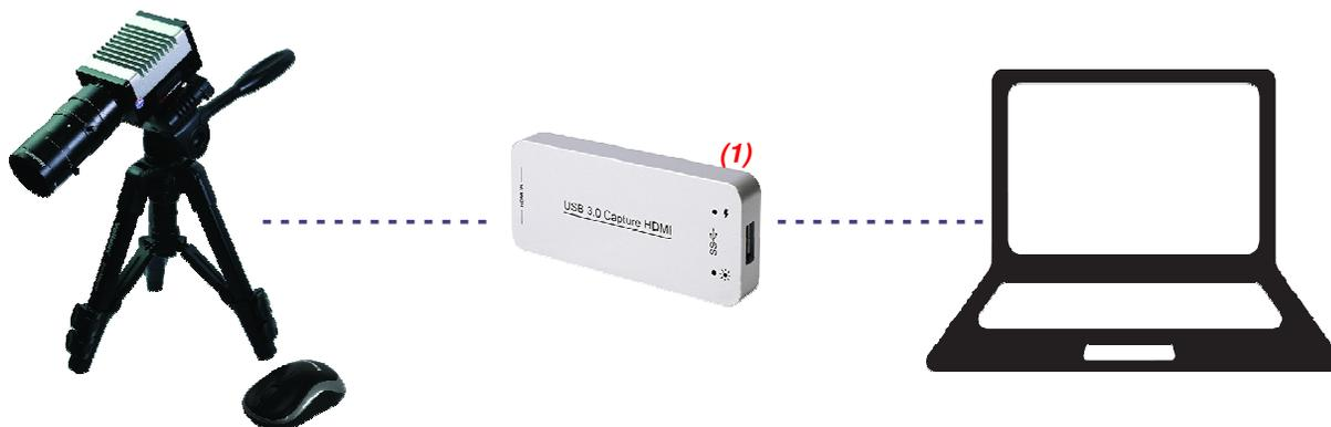
Collegate il vostro sistema d'ispezione HOROTEC (SMV-B / SMV-2 / SMV-3) con il convertitore di segnale HDMI/USB 3.0 (MSA14.151-U) e condividete la sua camera del sistema d'ispezione live utilizzando le seguenti applicazioni di videoconferenza :
